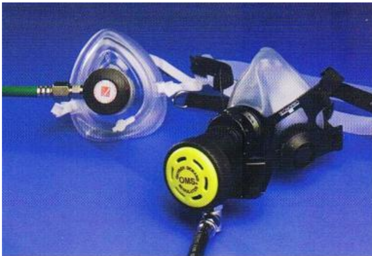
Zawory na żądanie dostarczają 100% tlenu medycznego uszkodzonym nurkowi, a ponieważ tlen jest zużywany tylko w czasie brania wdechu, powodują one oszczędne zużycie tlenu z butli
